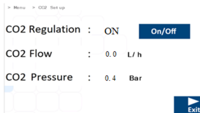
Abbildung 13.25 Anzeige des Untermenüs für die CO 2 -Einstellung im Mehrraum-IVF-Inkubator MIRI® TL6 und MIRI® TL12
